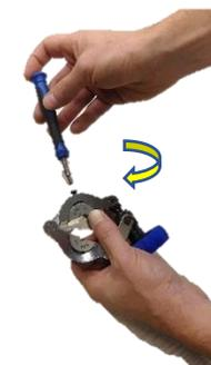
Fixation de la bague sur le tube de cuivre / *Fixing the clamp on the tube*
