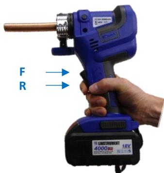
Appuyer sur la position F de la gachette jusqu'à la butée. Appuyer sur la position R pour rétracter le cône complètement avant de défaire la bague d'un quart de tour dans le sens des aiguilles d'une montre et de libérer le tube.
