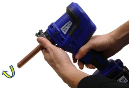
Serrer la bague sur la dudgeonnière en effectuant un quart de tour en sens inverse des aiguilles d'une montre
