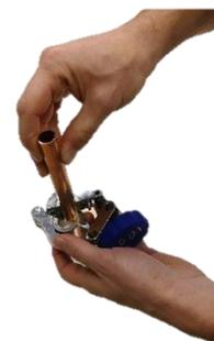
Placer le tube dans la filière et en butée sur la plaque d'arrêt. Serrer la baque en vissant la molette afin de maintenir le tube fermement
