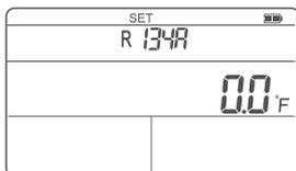
Fig. 7 Réglage de l'unité de température
