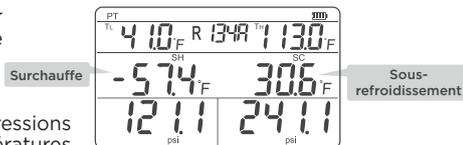
Fig. 2 Mode P/T avec affichage des surchauffe et sous-refroidissement
