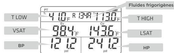
Fig. 1 Mode P/T avec les températures de saturations
